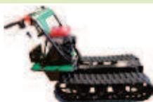
robusto con struttura in acciaio sciolto ad alto spessore che limita le vibrazioni ed il rumore, il baricentro basso inoltre assicura una ottimale stabilità durante il lavoro. La posizione del motore e della trasmissione agevola la manutenzione.
