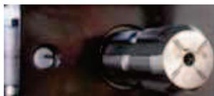
Il modello 1460 è dotato di PRESA DI FORZA con albero di  $\varnothing 1\ 3/8''$  a 6 scanalature per l'applicazione di attrezzi speciali. Il regime di rotazione massimo è di 800giri/min.
